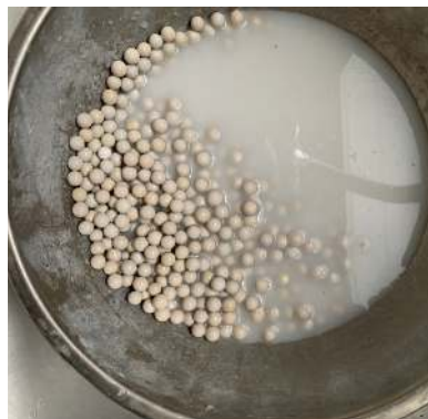
Figure 6 - Média neutralisant après rinçage à l'eau claire
